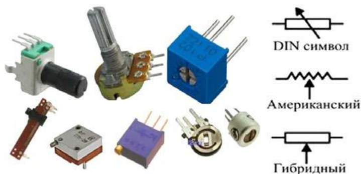
Рис. 10. Переменные резисторы (потенциометры)
