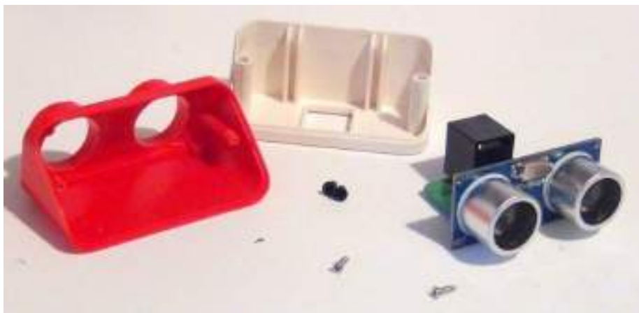
Рис.12 Ультразвуковой датчик расстояния КЛИК. Внутреннее строение
