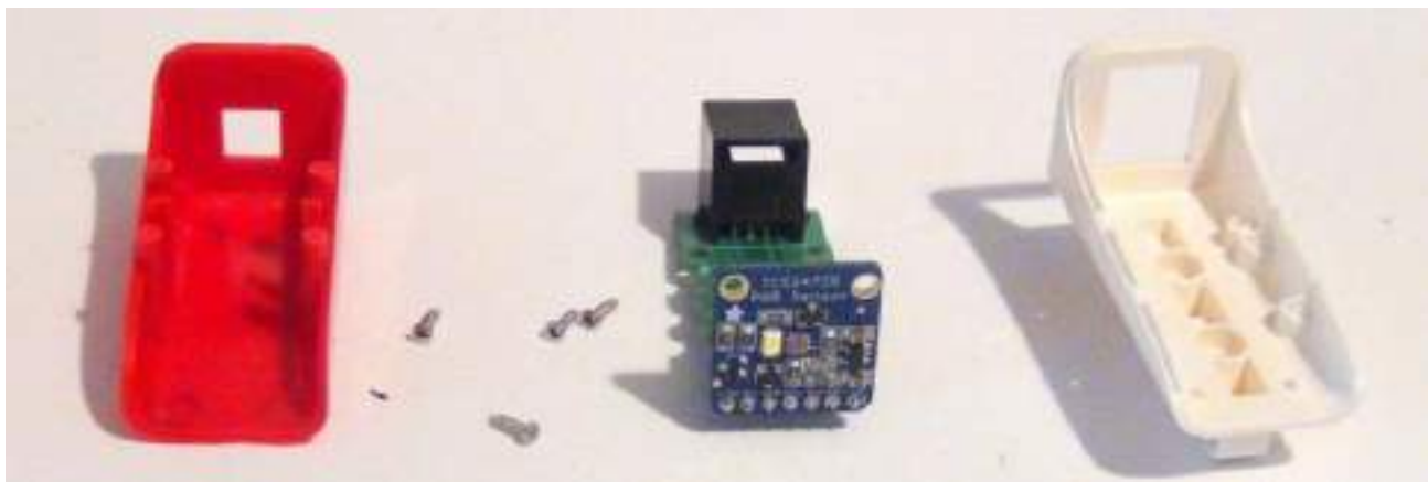
Рис.18 Датчик цвета КЛИК. Внутреннее строение
