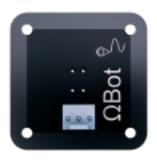
Датчик линии определяет отражающую способность поверхности. При подаче питания на модуль, инфракрасный светодиод начинает излучать свет, который отражаясь от белой поверхности попадает на фототранзистор. Как только в зону видимости датчика попадает чёрный объект, световой поток, поглощаясь этим самым объектом, перестаёт доходить до фототранзистора. Датчик линии выдает значение от 0 (самый белый) до 1023 (самый черный)
