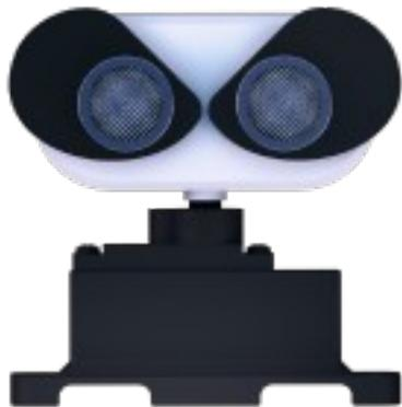
Дальномер работает по принципу эхолокации. Излучатель испускает неслышимый ультразвук в сторону препятствия. Звук отражается от препятствия и возвращается к датчику. Максимальное расстояние, на котором дальномер может определить препятствие - 400 мм
