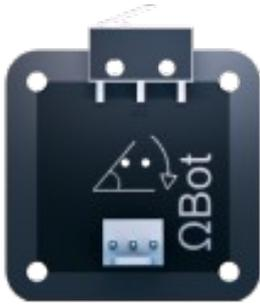
Модуль с концевым выключателем. При физическом контакте с препятствием происходит замыкание контактов, в результате чего вырабатывается соответствующий сигнал. 1 – есть касание, 0 – нет касания.
