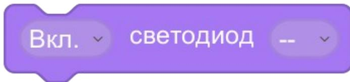
Этот блок включает/отключает светодиод. Для управления светодиодом он должен быть подключен к порту на плате Омегабота
