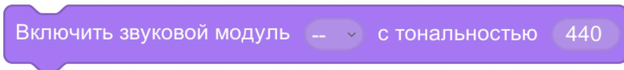
Этот блок включает звуковой модуль с указанной тональностью. Значение тональности может варьироваться от 0 до 1023. Для управления звуковым модулем он должен быть подключен к порту на плате Омегабота
