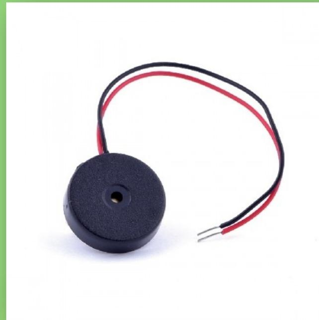
**Пьезоизлучатель** — устройство, способное воспроизводить звук, либо излучать ультразвук, благодаря обратному пьезоэлектрическому эффекту.
