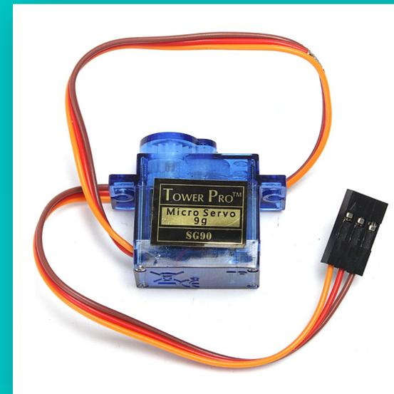
**Сервопривод** — это механизм с электромотором, который может поворачиваться в заданный угол и удерживать текущее положение.
