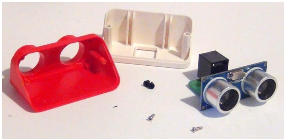
Рис.12 Ультразвуковой датчик расстояния КЛИК. Внутреннее строение
