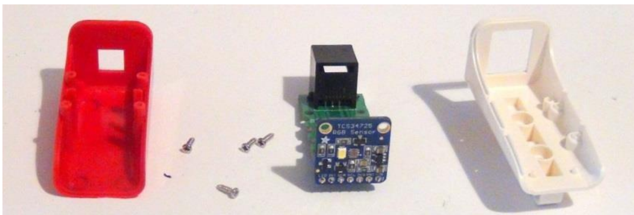
Рис.18 Датчик цвета КЛИК. Внутреннее строение
